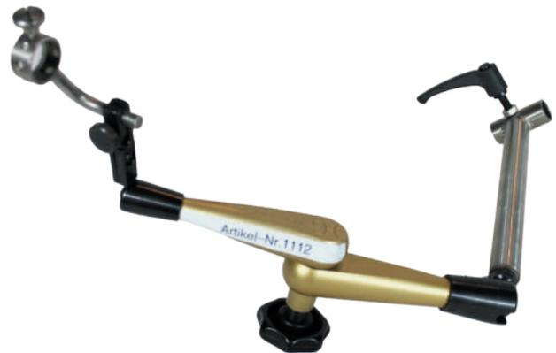
360° dreh- und schwenkbarer, hydraulischer Gelenkarm mit Zentralklemme über dem Spannkopf zur Verwendung mit dem R2SM V.3 Orbitalschweißgerät und dem LSM 20/SDT 170 Linear- & Drehteller-Schweißgerät.
