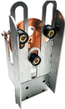
Massive Rondenplatte (Ø 150mm) aus Kupfer zum Anschweißen von Ankerplatten oder Fußplatten. Die Platten können mit dieser Vorrichtung sowohl vorder- als auch rückseitig, ohne vorheriges anheften oder zentrieren, angeschweißt werden.
