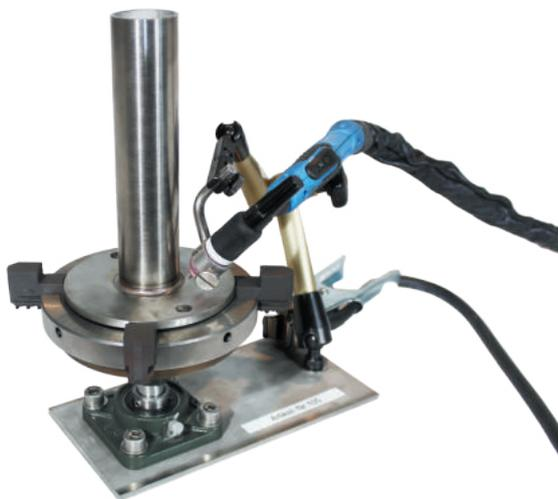
Diese Schweißvorrichtung ist für folgende Arbeiten gedacht. Ronden, Platten, Dorne und Stoßverbindungen an Rundprofile mit Durchmessern bis 170mm, ohne Massespuren am Werkstück, anschweißen.
