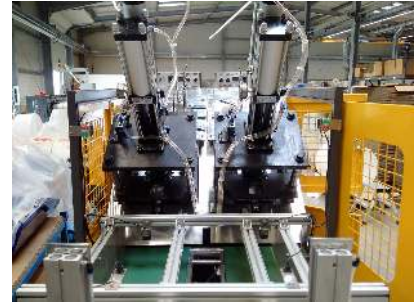
Die beiden unabhängig voneinander arbeitenden Prägestationen der ZDJ-800
