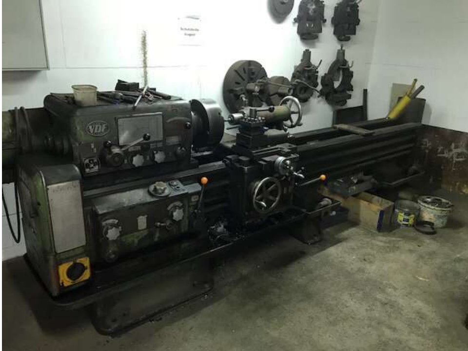
Drehbank für Eigenfertigung von Wellen, Buchsen und Reparaturteilen
